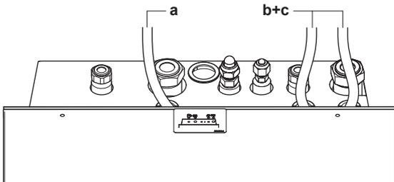
3 El tendido del cableado dentro de la unidad debe ser el siguiente:
