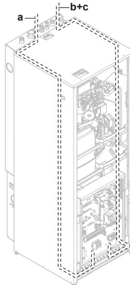
4 Fije el cable con abrazaderas a los sujetacables para garantizar que no haya tensión y asegurarse de que NO entra en contacto con las tuberías ni con bordes afilados.
