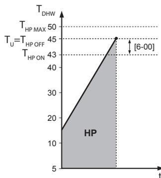
**HP** Bomba de calor. Si el tiempo de calentamiento por bomba de calor es excesivo puede activarse la resistencia de refuerzo para proporcionar un calentamiento adicional.
