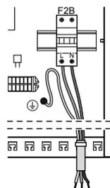
2 Fije el cable con abrazaderas a los sujetacables.
