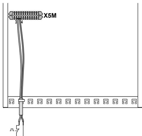
2 Fije el cable con abrazaderas a los sujetacables.
