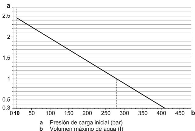
**Ejemplo: volumen máximo de agua y presión de carga inicial del depósito de expansión**
