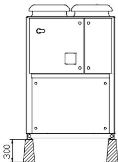
Para instalar los soportes antivibración, siga las instrucciones, en el diagrama de dimensiones suministrado con la unidad.
