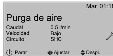
La función de purga de aire automática se detiene transcurridos aproximadamente 30 minutos. En este caso, el instalador debe reiniciar la función de purga de aire automática de la segunda zona de temperatura. Esta función también se detiene automáticamente transcurridos 30 minutos.
