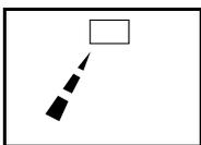
La indicación de la ALETA PARA RECIRCULACIÓN DE CAUDAL DE AIRE deja de moverse y la distribución de la circulación de aire queda fija en esa posición. (Ajuste de distribución fija de la circulación de aire).
