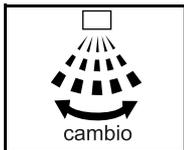
La indicación de la ALETA PARA RECIRCULACIÓN DE CAUDAL DE AIRE se mueve tal como aparece a continuación y la distribución de la circulación de caudal de aire irá cambiando continuamente. (Ajuste de deflexión automática)
