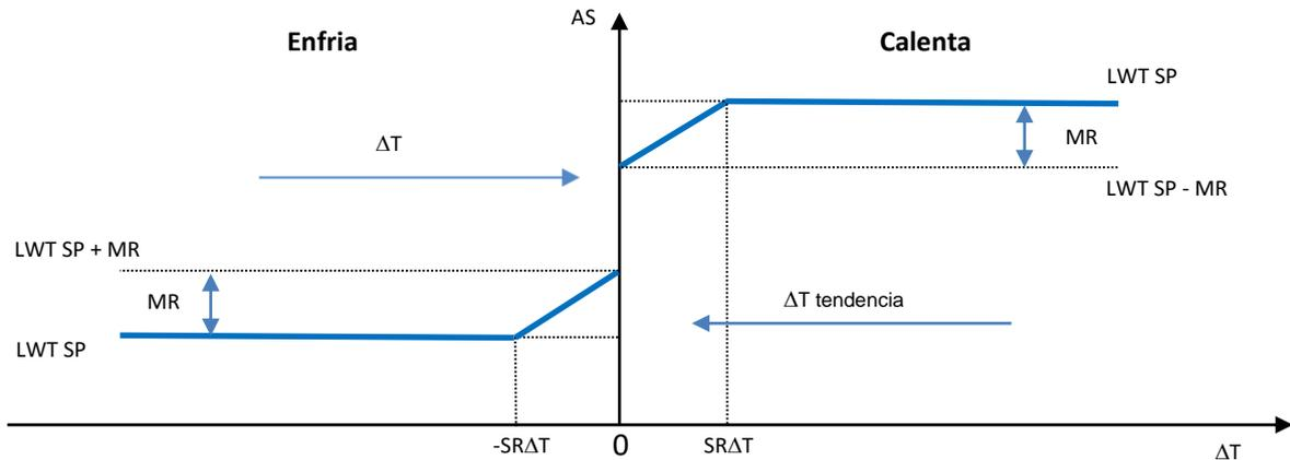
**Gráfico 4 Evap  $\Delta T$  vs Punto de Ajuste Activo - Modo de enfriamiento (izquierda)/ Modo de calentamiento (derecha)**
