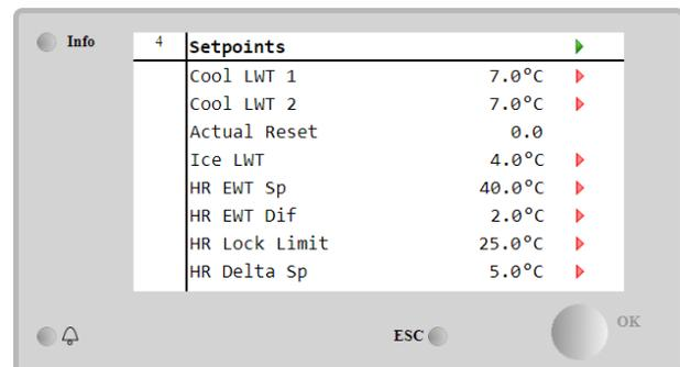
La unidad puede funcionar con un punto de ajuste primario o secundario, los cuales pueden gestionarse como se indica a continuación:
