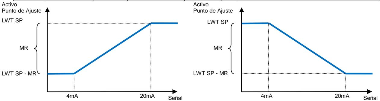
**Gráfico 3** Señal externa de 4-20 mA vs Punto de Ajuste Activo - Modo de enfriamiento (izquierda)/ Modo de calentamiento (derecha)
