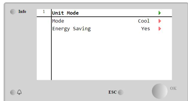
Dependiendo del tipo de unidad, pueden seleccionarse distintos modos operativos entrando, con la contraseña de mantenimiento, en el menú **Modo de Unidad**. En la siguiente table se listan y explican todos los modos.
