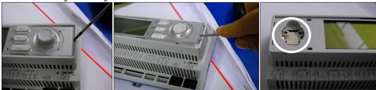
Tenga cuidado de no dañar la cubierta de plástico. Coloque la nueva batería en el sujetador de batería, que aparece resaltado en la imagen, respetando las polaridades indicadas en el sujetador mismo.
