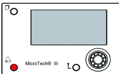
La HMI remota puede extenderse hasta 700 m mediante el proceso de conexión del bus disponible con el UC. Con una conexión en cadena, como se muestra debajo, una única HMI se puede conectar hasta con 8 unidades. Consulte el manual específico de la HMI para obtener detalles.
