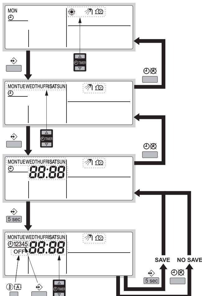
La programación del calentamiento del agua sanitaria o el modo susurrante se realiza del siguiente modo:
